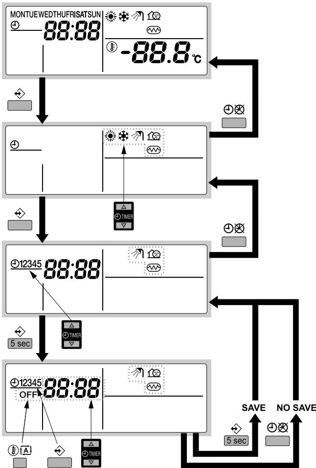
La programación del calentamiento del agua sanitaria, la resistencia eléctrica o el modo susurrante se realiza del siguiente modo:
